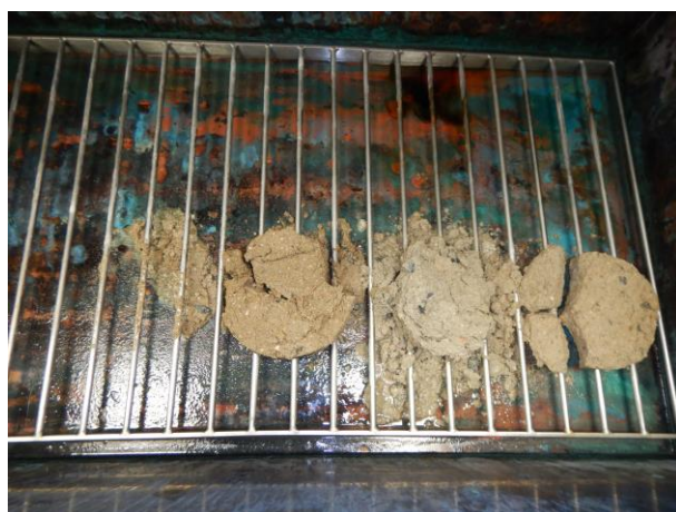
Obr. 3.18: vzorky betonu po 25-ti cyklech zkoušky odolnosti vůči CHRL
