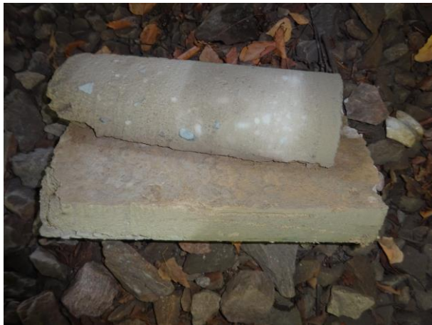
Obr. 3.7: Jádrový vývrt na rozhraní dvou betonových celků
