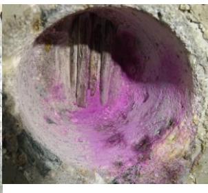
Obr. 3.10: Sonda P2 po aplikaci fenolftaleinu
