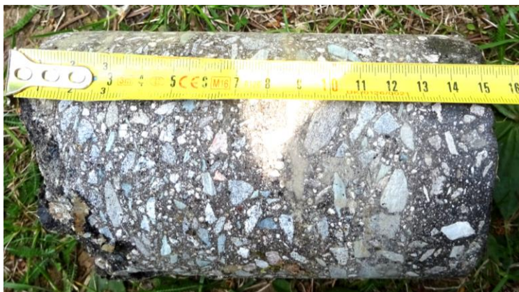
Obr. 3.37: Sonda S1: vývrt odebraný z asfaltobetonu
