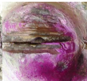
Obr. 3.12: Sonda P4 po aplikaci fenolftaleinu
