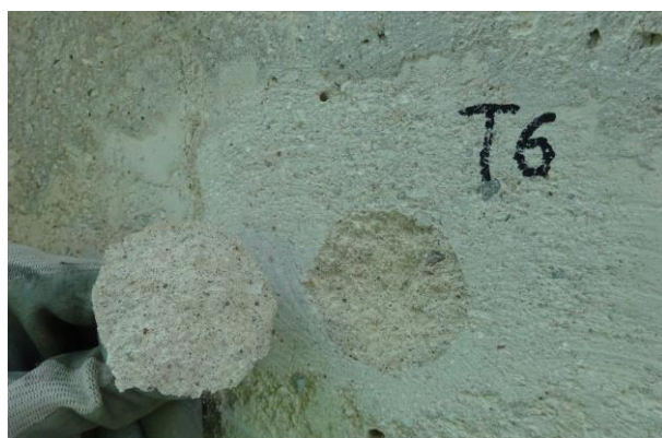
Obr. 3.36: Zkušební terč po odtržení, zkušební místo T6.
