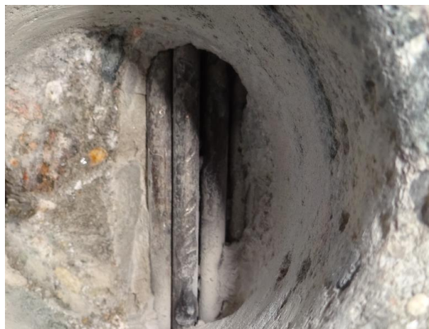
Obr. 3.30: Sonda P3, detail: kanálek zainjektovaný, část drátů bez koroze, část drátů mírná povrchová koroze, krytí 55 mm, beton v okolí kanálku nezkarbonatovaný
