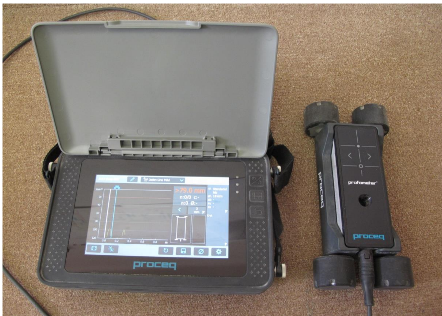
Obr. 2.1 Elektromagnetický indikátor: Profometr PM-6
