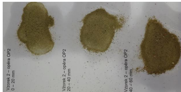
Obr. 3.14: Zkušební místo F2 – opěra O2, beton zkarbonatovaný do hloubky min. 60 mm
