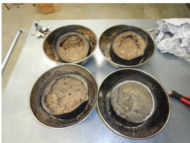
Obr. 3.17: vzorky betonu po 25-ti cyklech zkoušky odolnosti vůči CHRL
