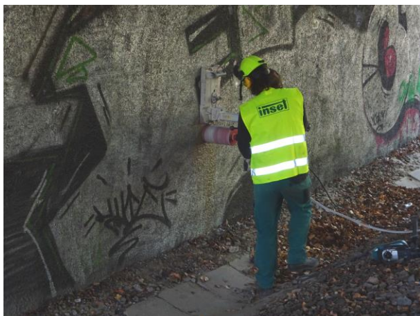
Obr. 3.5: Odběr jádrového vývrtu z opěry O2
