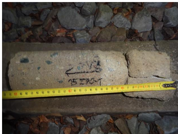
Obr. 3.6: Vývrt V3 odebraný z opěry O2, beton u povrchu se rozpadl na několik kusů
