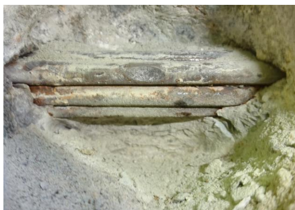
Obr. 3.32: Sonda P4, detail, kanálek zainjektovaný, ale injektáž není zcela soudržná, dráty napadeny povrchovou korozí, krytí 36 – 37 mm, beton v okolí kanálku nezkarbonatovaný
