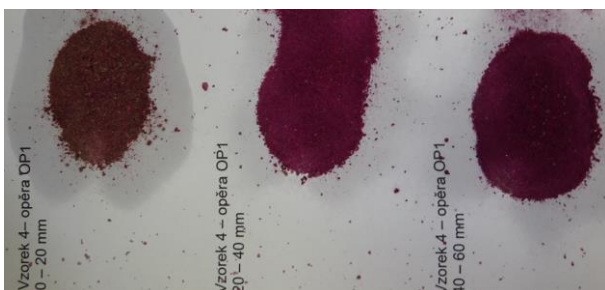
Obr. 3.16: Zkušební místo F4 – opěra O1, beton zkarbonatovaný do hloubky cca 40 mm
