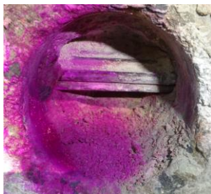
Obr. 3.9: Sonda P1 po aplikaci fenolftaleinu
