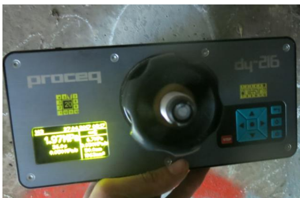
Obr. 3.35: Odtrhový přístroj DY-216 od firmy Proceq
