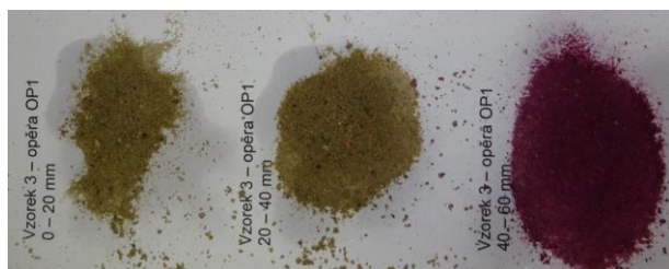
Obr. 3.15: Zkušební místo F3 – opěra O1, beton zkarbonatovaný do hloubky cca 40 mm
