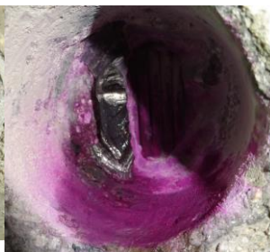
Obr. 3.11: Sonda P3 po aplikaci fenolftaleinu
