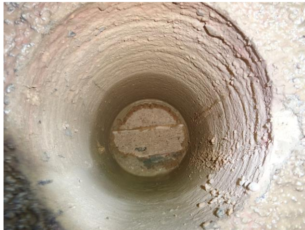
Obr. 3.8: Odvrt na rozhraní dvou betonových celků
